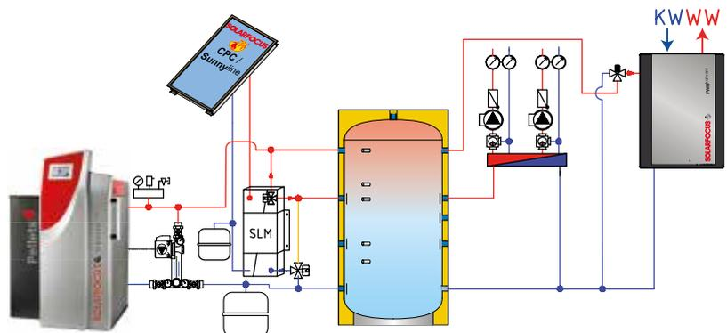
**thermi<sup>nator</sup> II** con puffer stratificatore, bollitore per acqua sanitaria ed impianto solare
