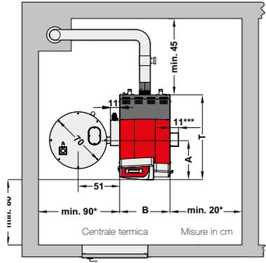
\* La parte posteriore della caldaia deve essere accessibile! (ca. 45 cm a sinistra o a destra)
