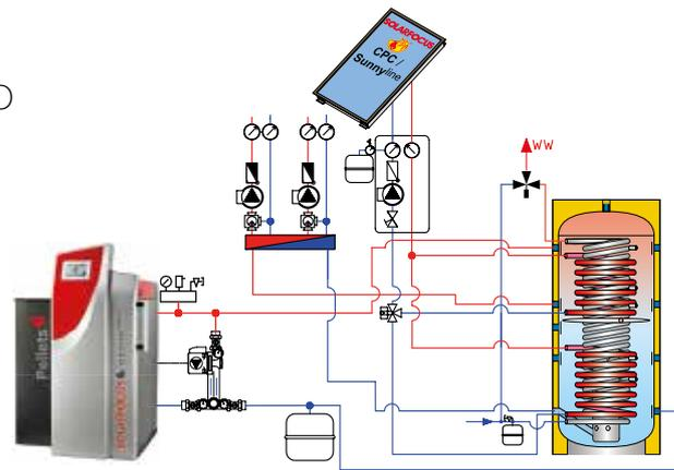
**thermi<sup>nator</sup> II** con puffer, modulo di carico solare stratificato, modulo per la produzione di ACS ed impianto solare
